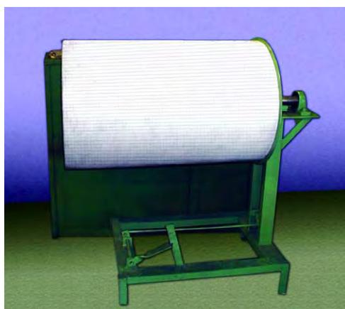
*Prensa compuesta (izquierda) y rodillo secador (derecha) usado para la producción de cordón flexible para soldadura*
