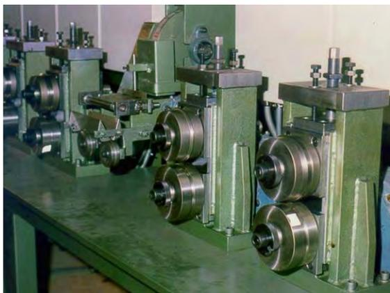
*Producción de alambre para soldadura de núcleo fundente.*
